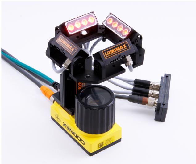
Es können dabei verschiedene Aufsichtbeleuchtungen eingesetzt werden. Voraussetzung ist, dass sich die Beleuchtungen in einzelnen Segmenten umlaufend um das Prüfobjekt schalten lassen.
