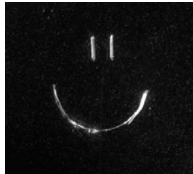
Kratzer auf Plexiglas - Dunkelfeld-Durchlicht
