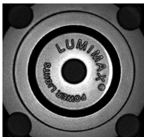
Klassische Bildaufnahme mithilfe einer LED Ringbeleuchtung
