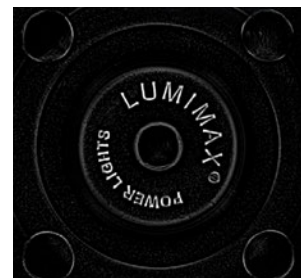
Im Ergebnis heben sich die gefrästen Zeichen deutlich ab
