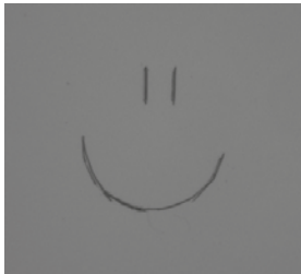
Kratzer auf Plexiglas - diffuses Durchlicht
