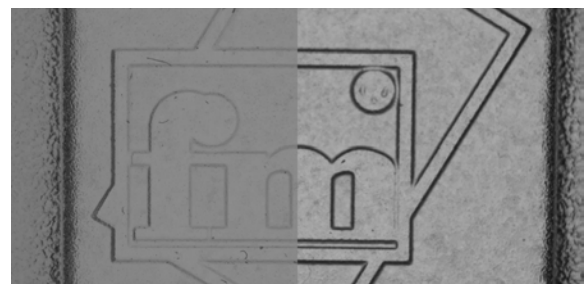
Transparenter Kunststoff mit Prägung - diffuses Durchlicht
