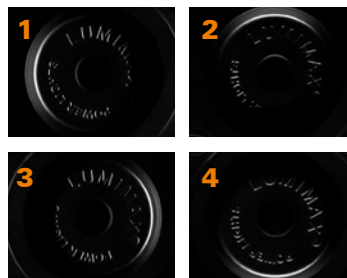
Shape-from-Shading Bildaufnahme mithilfe von 4 Miniaturbalken der LSB-Serie
