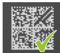
Gelasertes Code auf Kunststoffoberfläche
