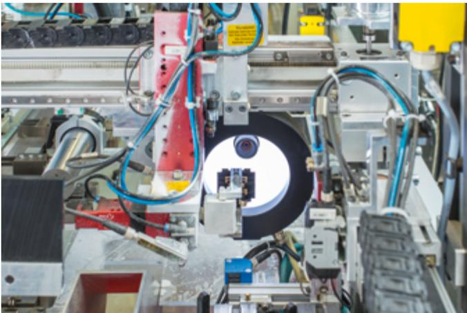
Verifikations-System mit LUMIMAX<sup>®</sup> Dornbeleuchtung in einer Fertigungsstrecke des Siemens Gerätewerks Amberg
