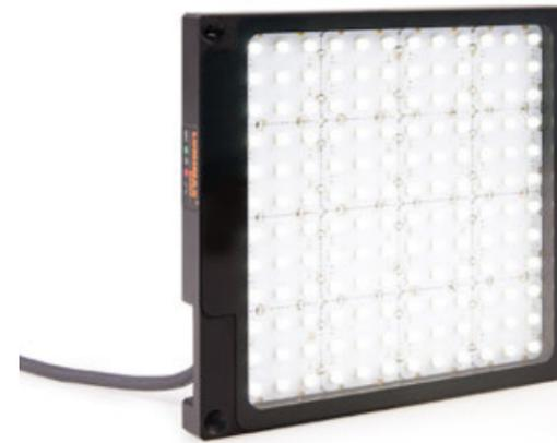
Die Flächenbeleuchtungen der BF-Serie sind vielfältig in allen Bereichen der industriellen Bildverarbeitung einsetzbar. Eine Variante mit gerichteter Lichtführung (30° LED-Abstrahlwinkel) kann für Auflichtanwendungen genutzt werden. Für Durchlichtanwendungen steht eine hochdiffuse Variante zur Verfügung.
