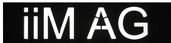
Stanzteil im Durchlicht
