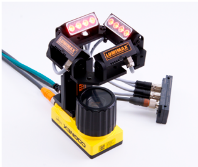
Geeignete Beleuchtung für Shape-from-Shading Anwendungen: LUMIMAX ® Miniatur-Balkenbeleuchtungen in vierseitiger Montagehalterung
