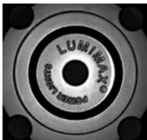
Klassische Bildaufnahme mithilfe einer LED Ringbeleuchtung
