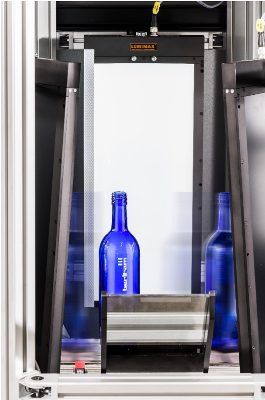
Bild 2 Dank der kollimierten Flächenbeleuchtungen von LUMIMAX zeichnen sich Kanten oder Produktionsfehler deutlich auf dem Prüfbild ab
