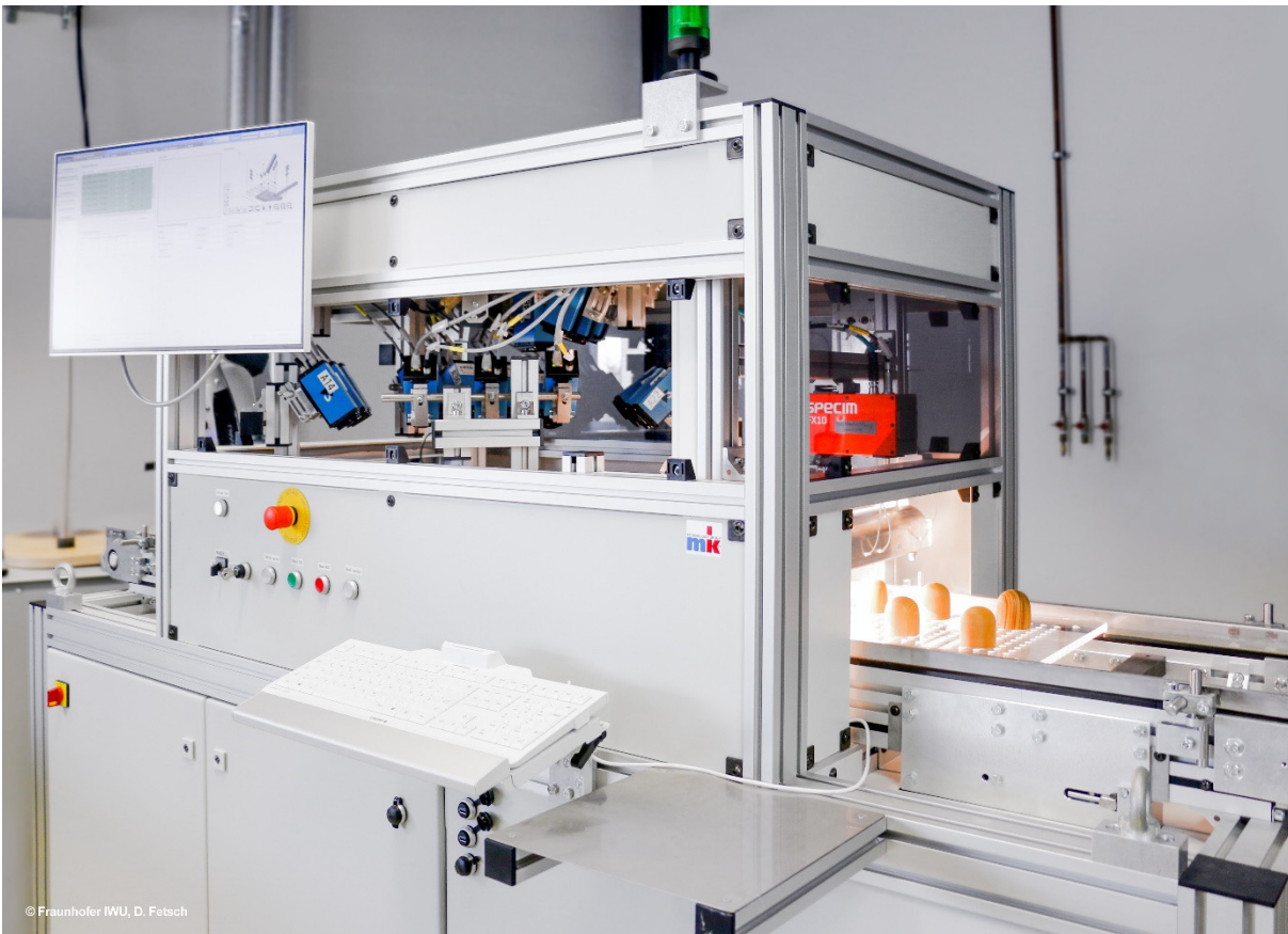
Abbildung 1 Demonstrationsanlage des Projektes IQZeProd zur vollautomatischen Prüfung von Holz-, Kunststoff- oder Metallteilen und lackierten Oberflächen
