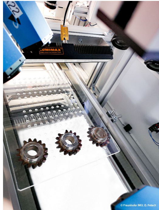
Abbildung 3 Sonderflächenbeleuchtung der Marke LUMIMAX® ermöglicht die Ausleuchtung von nahezu der gesamten Breite der Prüfanlage
