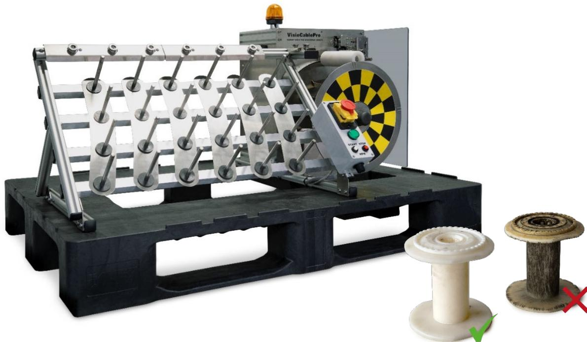
Der neue automatische Spulenabwickler ABU24 der Marke VisioCablePro® - Im Vergleich: neue (links) vs. alte Flechtspule (rechts)
