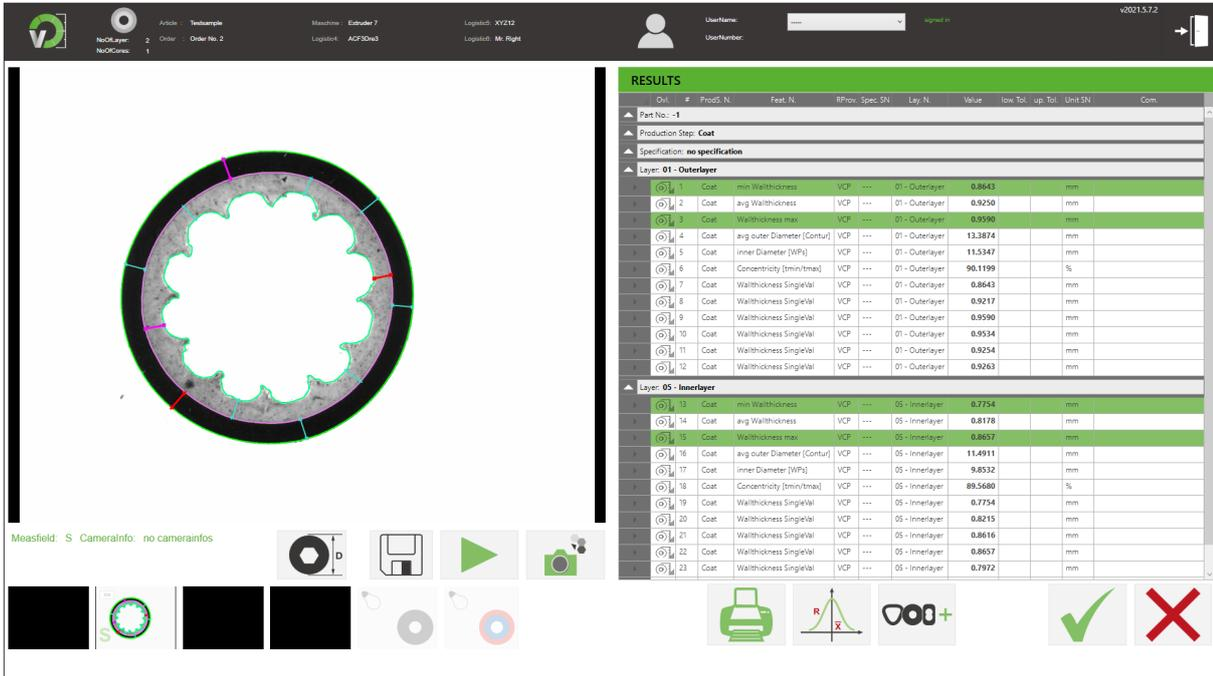
El software de medición VELOX evalúa de manera confiable los resultados de medición que han sido registrados por el dispositivo de medición VCPX5 y el instrumento AlphaOne está equipado con algoritmos de procesamiento de imágenes de última generación.
