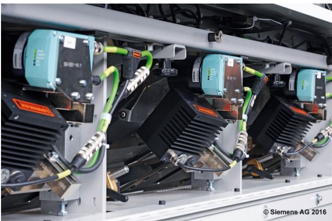
Abbildung 2 Auf engstem Raum konnten die LUMIMAX® UV-LED-Blitzbeleuchtung LQ100 und das optische Lesesystem Simatic MV440 optimal in den Herstellungsprozess integriert und somit die Prozesssicherheit gewährleistet werden
